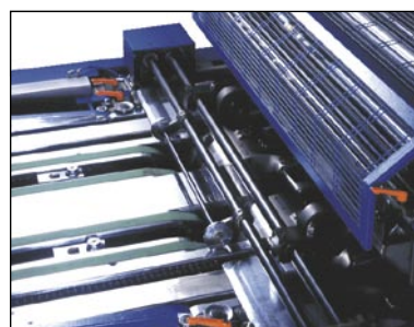
Tamburo di registro frontale Registri laterali e spingifogli Register drum Sidelay and sheet pushers
