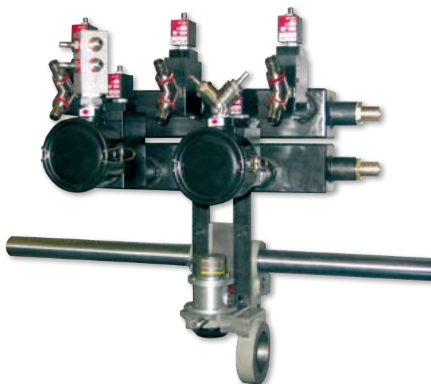
Sistema distribuzione aria elettronico per mettfoglio Feeder electronic air distribution system
