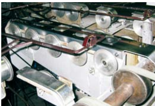
Ingresso forno: freno a vuoto del foglio Oven infeed: vacuum sheet brake
